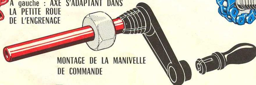
MONTAGE DE LA MANIVELLE DE COMMANDE
