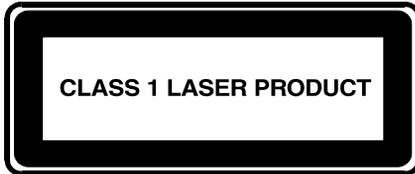
Cette étiquette indique que le produit est répertorié comme PRODUIT LASER DE CLASSE 1. Elle figure sur l'équipement laser installé dans le produit.
