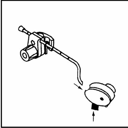
12. Pour accrocher le "Seat 2 Go" à votre landau ou votre poussette, presser sur les boutons rouges situés de chaque côté de la marche-siège (C), insérer la tige (D) jusqu'au fond puis relâcher le bouton rouge pour la bloquer. Attention de bien vérifier que les tiges (D) sont parfaitement insérées et bloquées avant utilisation. Si vous souhaitez retirer le "Seat 2 Go" de la poussette, vous devrez presser à nouveau les boutons rouges.
