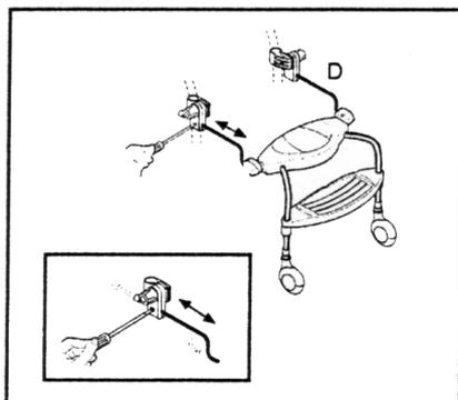
10 . Echangez la pièce (Z) avec la pièce (W) déjà attachée au tube (D) et vissez-la avec
