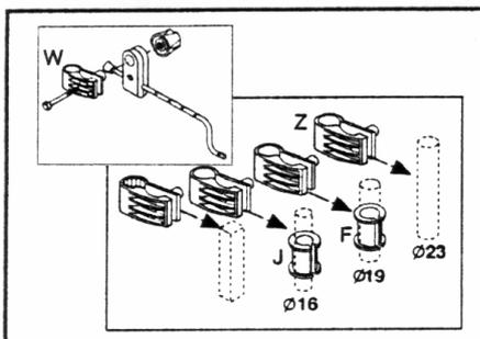
7 . Choisissez la taille et le type d'attaches correspondant à votre landau ou poussette. Cela dépend de la forme et de la taille des tubes. Pour un tube carré, utilisez la pièce (W) déjà rattaché à la pièce (D).
