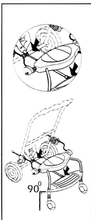
Fixer la barre de maintien à la marche du Seat2Go jusqu'au « clic », puis à la poussette en utilisant les sangles équipées de Velcro. Cette partie permet de fixer la barre de maintien à toutes les sortes de poussettes équipées de tous les types de tubes. Il est recommandé de fixer la barre de maintien de façon qu'elle soit aussi parallèle que possible au sol.
